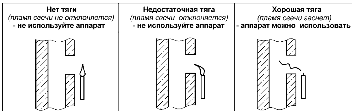
Рисунок 7. Способ проверки тяги в дымоходе
