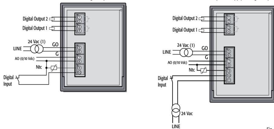
(1) In alternativa è possibile alimentare il controllo a tensione continua / Alternatively, it is possible to supply the control with continuous voltage
