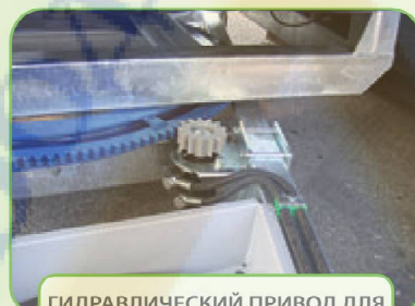
ГИДРАВЛИЧЕСКИЙ ПРИВОД ДЛЯ ПОВОРОТА ПЛАТФОРМЫ
