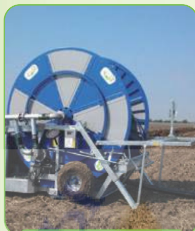
ГИДРАВЛИЧЕСКИЙ ПРИВОД ОПОРНЫХ ЛАПОК
