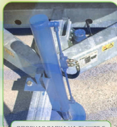
ОПОРНАЯ ЛАПКА НА ДЫШЛЕ С ГИДРАВЛИЧЕСКИМ ПРИВОДОМ
