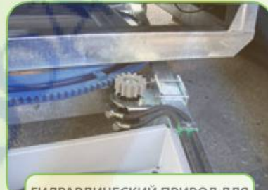
ГИДРАВЛИЧЕСКИЙ ПРИВОД ДЛЯ ПОВОРОТА ПЛАТФОРМЫ
