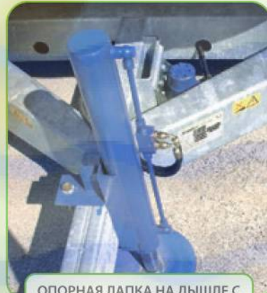
ОПОРНАЯ ЛАПКА НА ДЫШЛЕ С ГИДРАВЛИЧЕСКИМ ПРИВОДОМ
