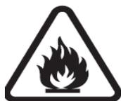
В местах, обозначенных данным знаком, возникает непосредственная опасность контакта с пламенем
