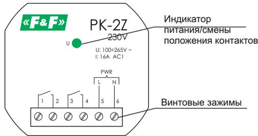
Реле электромагнитное PK-2Z выполнено в корпусе для крепления в монтажную коробку Ø60 мм. На передней панели находится индикатор питания/смены положения контактов исполнительного реле.
