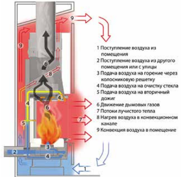
Потоки движения воздуха в топке Вега
