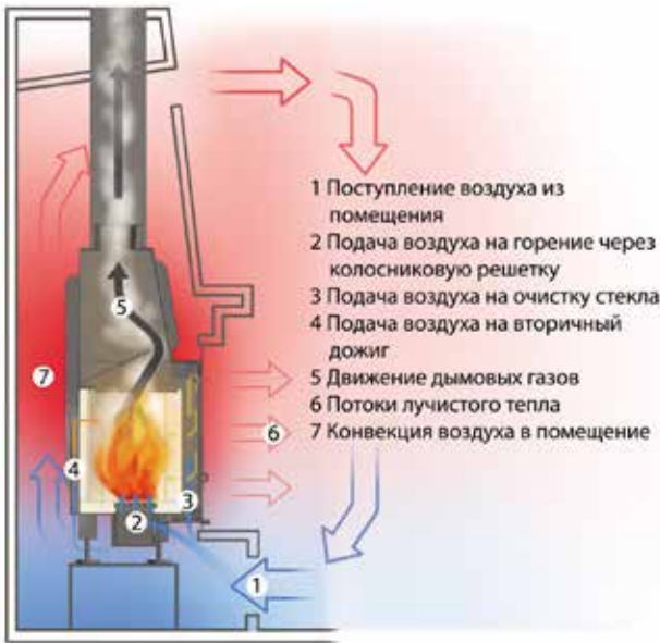
Потоки движения воздуха в топке Альфа
