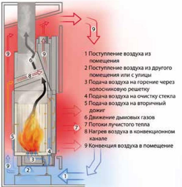
Потоки движения воздуха в топке Дельта
