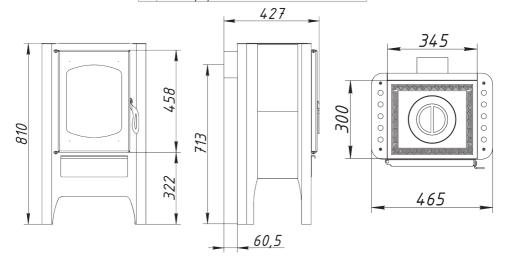
Технические характеристики Диаметр патрубка – 120 мм ВхШхГ (мм) – 810х465х427 Номинальная мощность (кВт) – 6 Вес (кг) – 70
