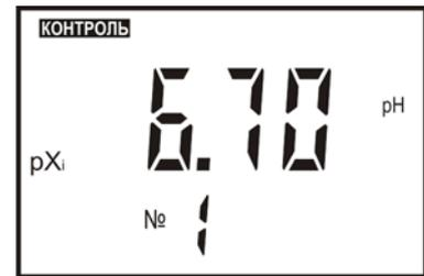
При каждом нажатии кнопки **ВВОД** последовательно выводятся значения координат изопотенциальной точки  $pX_i$ ,  $E_i$  и крутизна электродной системы  $S$  при 25 °С обоих каналов измерения, после чего прибор автоматически переходит в режим измерения. При просмотре параметров электродной системы на вспомогательном цифровом поле дисплея индицируется номер канала измерения (№ 1 – электродная система pH, № 2 – электродная система измерения натрия).
