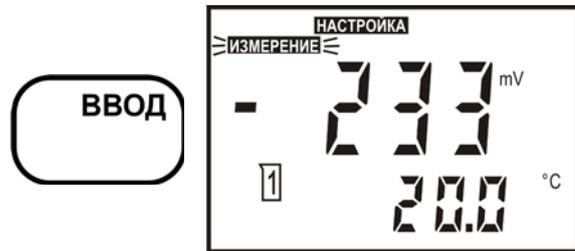
Прибор предлагает ввести концентрацию (активность) градуировочного раствора. На дисплее отображается значение рХ (сХ) первого градуировочного раствора, использовавшегося при последней градуировке (в первый раз – установленное производителем прибора).
