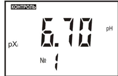
Для изменения значений координат изопотенциальной точки одной из электродных систем следует, при просмотре значения  $pX_i$  выбранного канала измерения нажать кнопку **ВВОД** и удерживать ее в течение 1-2 сек.
