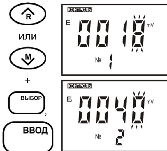
Прибор предложит выполнить градуировку выбранного канала измерения (6.1 или 6.2), причем градуировка канала измерения ионов  $Na$  предлагается выполнить в тех единицах измерения, которые были на дисплее прибора в момент вхождения в режим «**КОНТРОЛЬ**».
