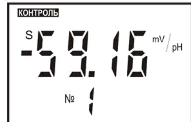
Переход в режим «**ИЗМЕРЕНИЕ**» на любом этапе может производиться нажатием кнопки **РЕЖИМ**.
