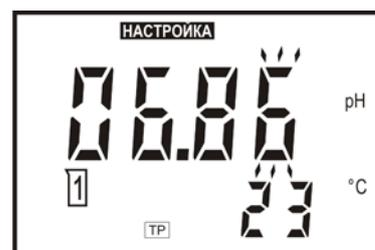
Для занесения значения pH первого градуировочного раствора в память прибора следует нажать кнопку **ВВОД**.
