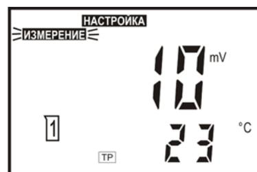
На основании полученных данных прибор автоматически определит ближайший, соответствующий этим данным раствор из перечня рабочих эталонов (приложение А) и выведет на дисплей значение его рН для температуры 25 °С.
