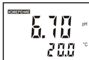
Для измерения показателя активности или отсчета показаний в единицах массовой концентрации ионов натрия, следует в правой части дисплея установить кнопкой **ВЫБОР** единицы измерения «pX» или «g/l», соответственно (5.1). Размерности «g/l», «mg/l» или «µg/l» переключаются автоматически.
