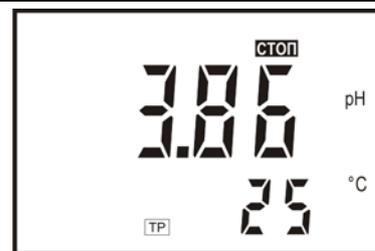
При нажатии на кнопку **РЕЖИМ** измерение возобновляется.
