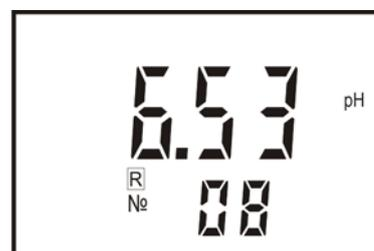
Нажатием кнопок  $\vee$  и  $\wedge$  можно выбрать любую другую ячейку блокнота от 1 до 30. На дисплее выводится значение pH, рХ, сХ или мВ, сохраненное в ячейке под выбранным номером.
