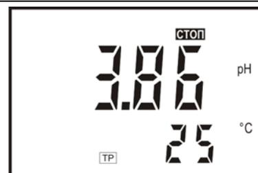
Нажать кнопку  $\nabla$ . Готовность прибора к сохранению результата индицируется на дисплее знаком «M». На основном поле дисплея сохраняются результаты последнего измерения, на вспомогательном цифровом поле выводится номер ячейки, следующей за последней заполненной ранее.
