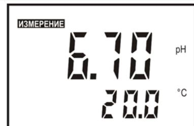
Если значение pH меньше 10 следует осмотреть магистрали подачи анализируемой воды (анализируемый раствор должен поступать в измерительную ячейку в соответствии с 4.4.7), проверить наличие в бачке 22 (рисунок 4) раствора аммиака требуемой концентрации.
