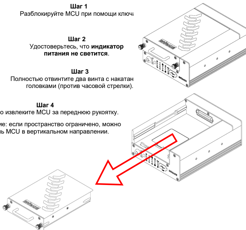
Рисунок 10: Извлечение мобильного контейнера с жестким диском, MDR-504xx-500
