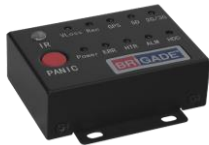
Панель дистанционного управления, индикации статуса и интерфейса MDR MDR-RP-01-P
