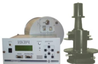
пульсаций оптической плотности дымовых потоков, а также массовой концентрации взвешенных частиц (пыли) через пересчетную функцию с выдачей звуковой и световой сигнализации при превышении концентрацией предварительно установленных пороговых значений и формированием управляющего воздействия для включения (отключения) исполнительных устройств посредством контактов реле.
