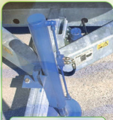
ОПОРНАЯ ЛАПКА НА ДЫШЛЕ С ГИДРАВЛИЧЕСКИМ ПРИВОДОМ
