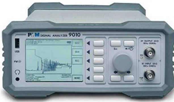
• Современный цифровой приёмник радиопомех с частотой 30 МГц является базовой системой. Основанный на непосредственном аналого-цифровом преобразовании и сложных компьютерных расчётах, он обеспечивает работу без необходимости калибровки почти всех своих основных компонентов, таких как: широкополосных фильтров, датчиков, демодулятора.... В то же время входной каскад для радиочастотных сигналов калибруется самостоятельно с помощью внутреннего генератора
