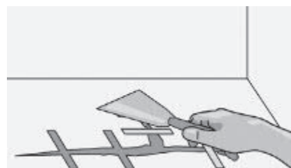
Рис. 6. Убрать выступающую на поверхность смолу
