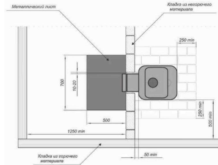
Рис. 2. Схема установки печи (вид сверху)
