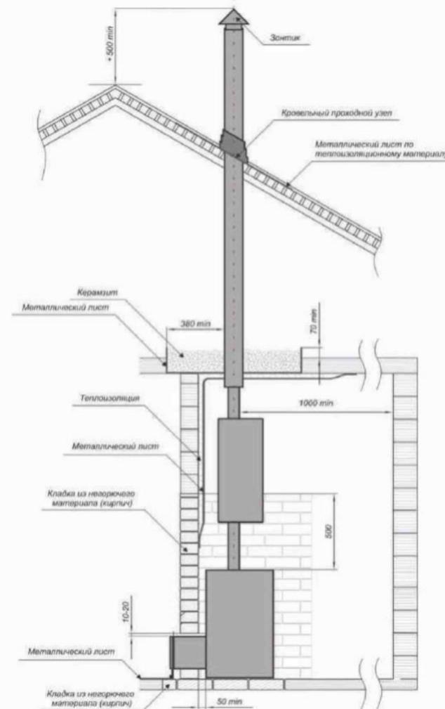
Рис. 3. Схема установки печи (вид сбоку)
