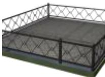
№5 каркас из квадратной трубы 20мм,рисунок из катанки 6мм высота 40мм
