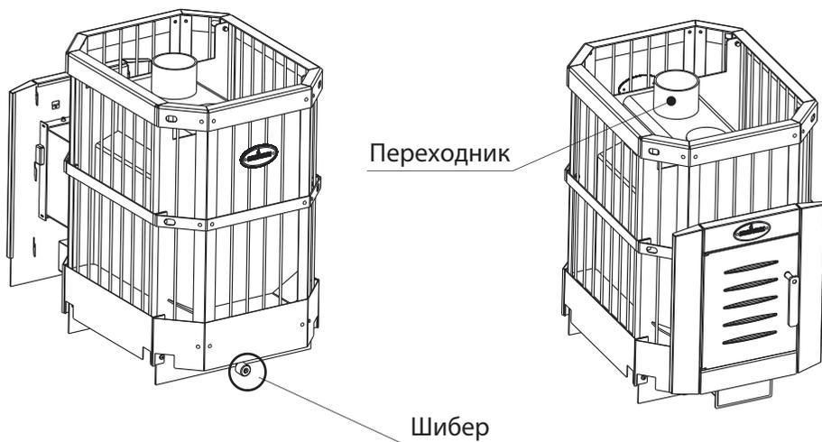
Рисунок 2. Печь Кирасир Corbis Standard (вид сзади)
