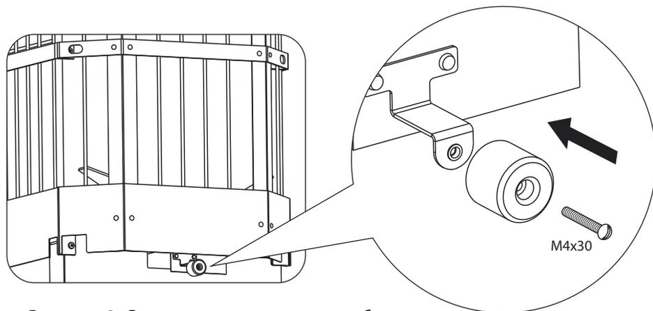
Рисунок 8. Схема установки ручки шибера
