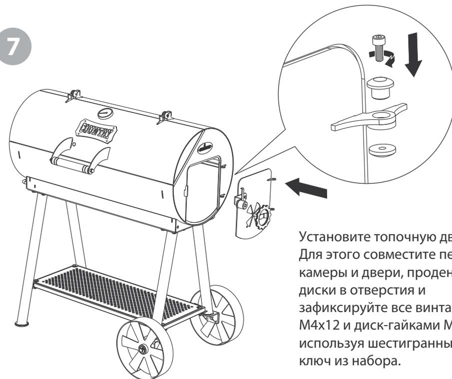
Установите топочную дверь. Для этого совместите петли камеры и двери, проденьте диски в отверстия и зафиксируйте все винтами М4х12 и диск-гайками М4, используя шестигранный ключ из набора.
