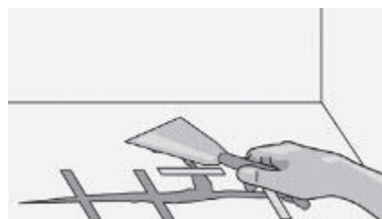
Рис. 6. Убрать выступающую на поверхность смолу
