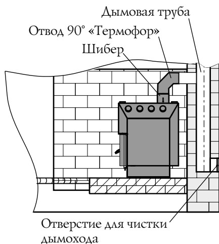
Рисунок 13. Схема присоединения котла к стационарному дымоходу
