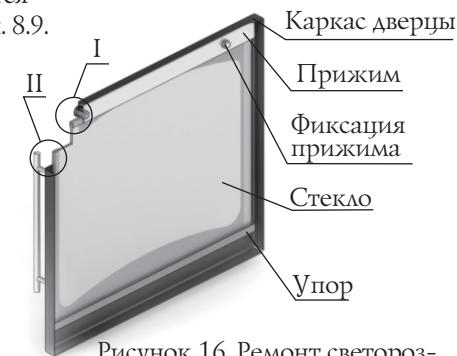
Рисунок 16. Ремонт светорозрачного экрана двери модели «Витра»
