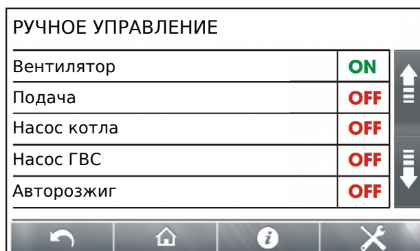
Рис. 8 Вид окна ручного управления, где OFF - означает, что устройство выключено, ON - включено.
