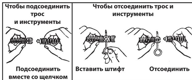
Рис. 1: Соединение и разъединение тросов и инструментов
