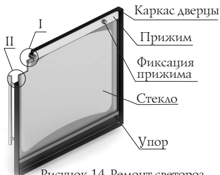
Рисунок 14. Ремонт светорозрачного экрана дверцы модели «Витра»
