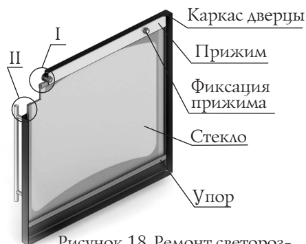
Рисунок 18. Ремонт светопрозрачного экрана дверцы модели «Тунгуска Витра»
