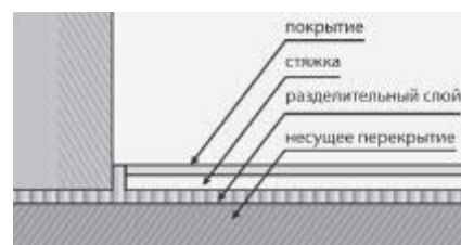
Рис. 14. Стяжка на разделительном слое
