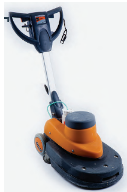
Шлифовальная машина Для шлифовки основания.
