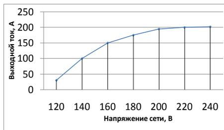
В результате понижения входного напряжения будет наблюдаться спад выходной мощности сварочного аппарата
