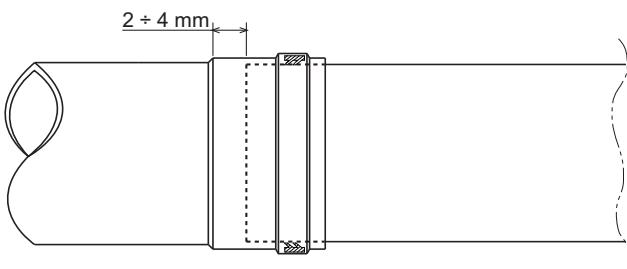
рис. 8 - Тепловое расширение
