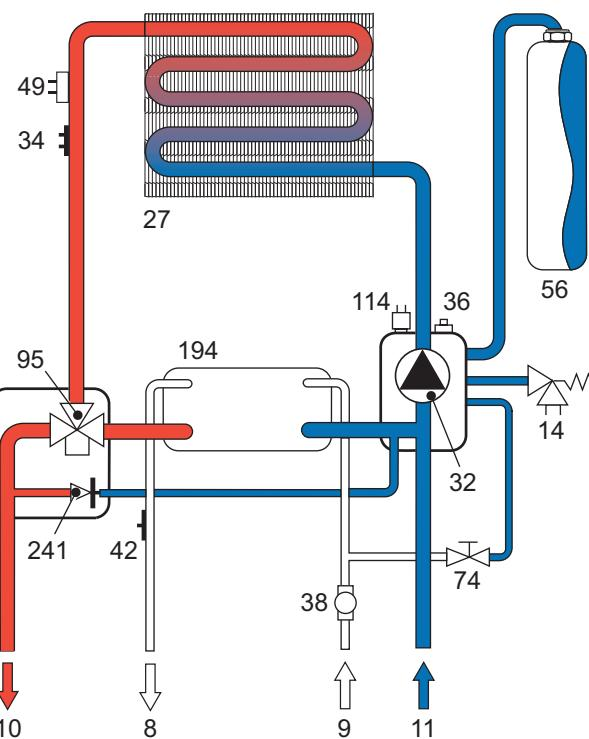
рис. 18 - Отопительный контур
