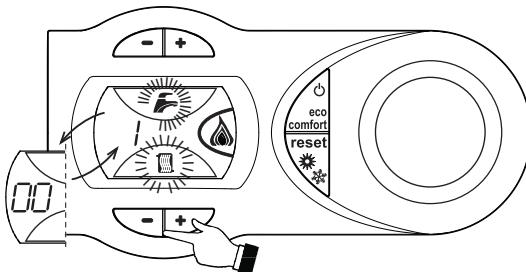
рис. 14 - Режим TEST (мощность системы отопления = 100%)
