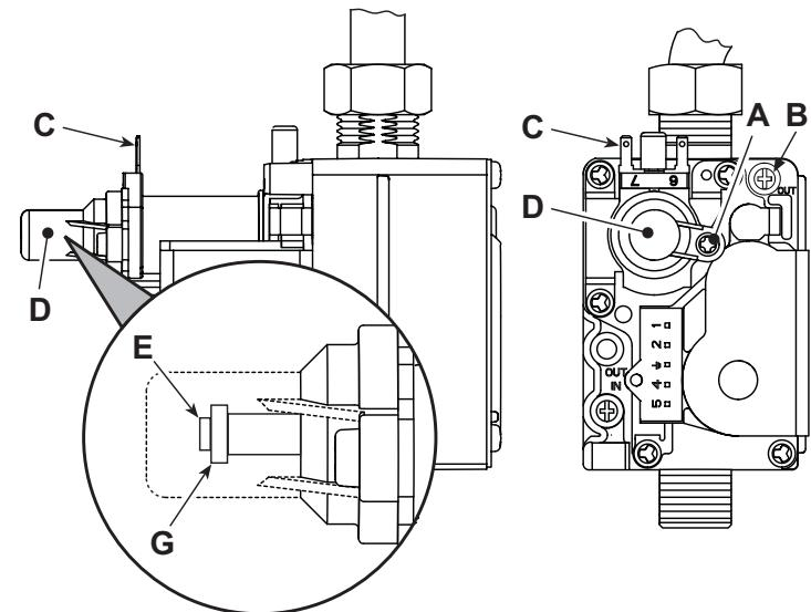
рис. 15 - Газовый клапан
