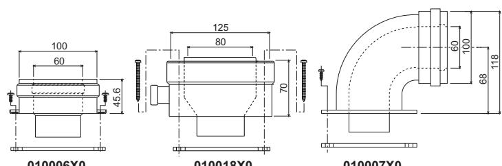
рис. 10 - Начальные элементы для коаксиальных воздуховодов
