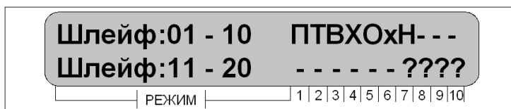
Рисунок 7 – Обзор состояния шлейфов сигнализации
