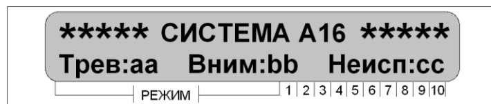
Рисунок 4 – Дежурный режим работы ВПУ-А-16 (наличие зарегистрированных событий)
