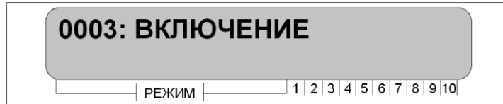
Рисунок 2 – Отображение на ЖК-дисплее ВПУ-А-16 при включении ППК «А16-512»
