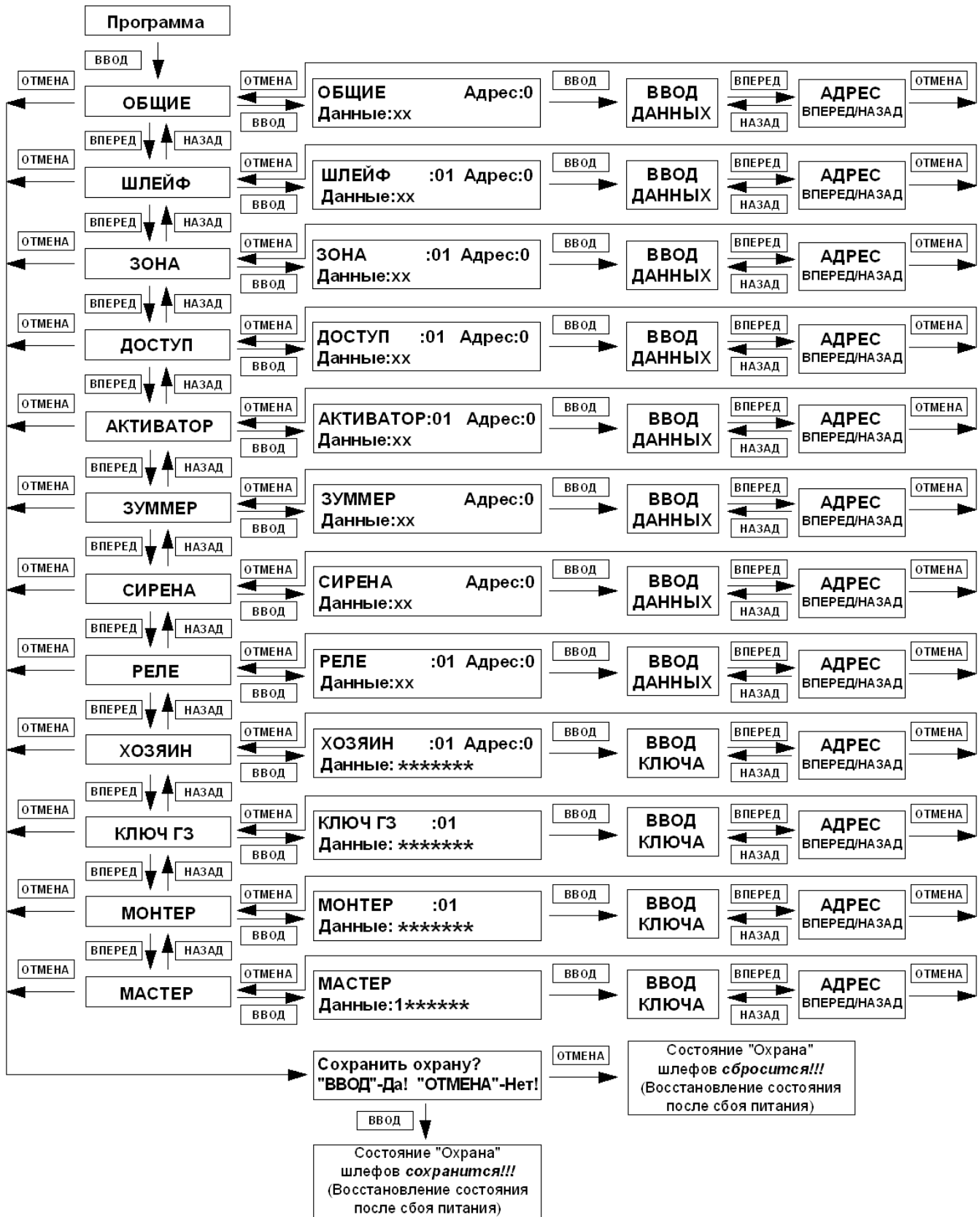
Рисунок 22 - Блок-схема работы клавиатуры в режиме «Программа»
