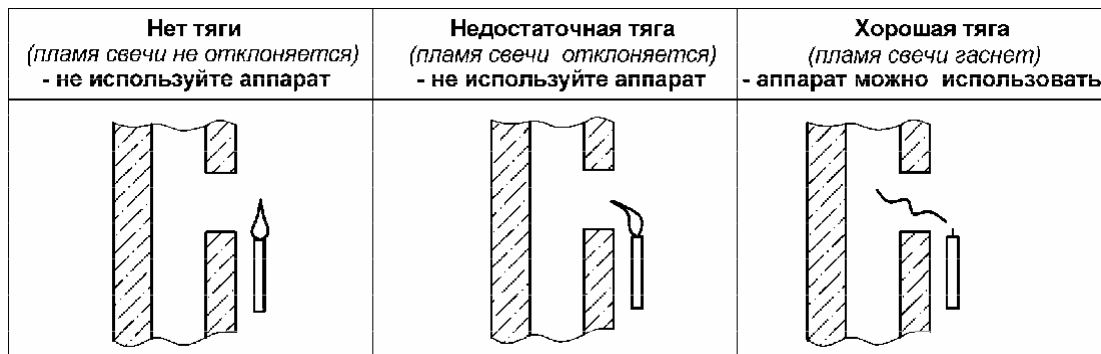
Рисунок 4. Способ проверки тяги в дымоходе
