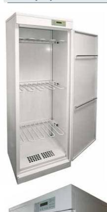
Сушильный шкаф «Hotstorm» предназначен для сушки мокрой одежды, обуви, белья, а также разлчной спортивной формы и инвентаря. Внутри шкафа есть три секции для подвески одежды. Средняя и нижняя секции откидываются вверх для удобства сушки длинной одежды. Шкаф можно подсоединить к вытяжной вентиляции. Для этого на крыше шкафа имеется фланец для подсоединения гофротрубы.
