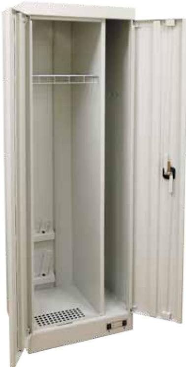
Сушильный шкаф Универсал-2000 применяется для сушки влажной и мокрой одежды и обуви. Шкаф имеет два вертикальных отдела, оснащен четырьмя штангами для обуви, сетчатой полкой для головных уборов или перчаток.
