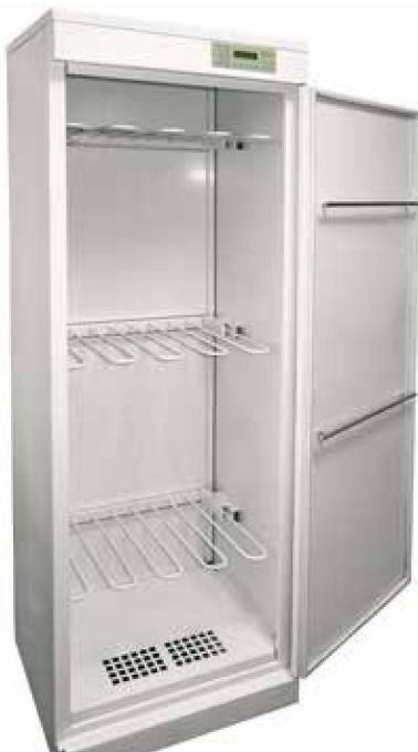
Сушильный шкаф «Hotstorm» предназначен для сушки мокрой одежды, обуви, белья, а также различной спортивной формы и инвентаря. Внутри шкафа есть три секции для подвески одежды. Средняя и нижняя секции откидываются вверх для удобства сушки длинной одежды. Шкаф можно подсоединить к вытяжной вентиляции. Для этого на крыше шкафа имеется фланец для подсоединения гофротрубы.
