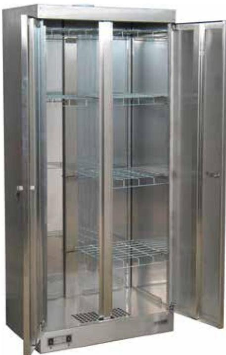
Сушильный шкаф ШСО-2000Н используется для сушки влажной и мокрой одежды и обуви. Внутри шкафа расположены съемные сетчатые полки, которые позволяют оптимально использовать пространство шкафа (сушить одежду различной длины). Шкафы сушильные ШСО-2000Н могут быть подсоединенены к вытяжной вентиляции. Для этого на крыше шкафа располагается фланец для гофротрубы. Шкаф изготовлен из нержавеющей стали
