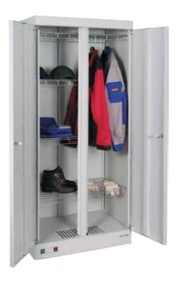
Сушильный шкаф ШСО-2000 используется для сушки влажной и мокрой одежды и обуви. Внутри шкафа расположены съемные сетчатые полки, которые позволяют оптимально использовать пространство шкафа (сушить одежду различной длины). Шкафы сушильные ШСО-2000 могут быть подсоединены к вытяжной вентиляции. Для этого на крыше шкафа располагается фланец для гофротрубы. Сушильный шкаф ШСО -2000Б применяется для сушки бронежилетов в количестве 10-12 штук.
