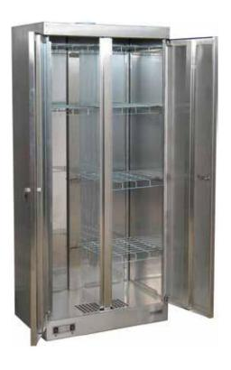
Сушильный шкаф ШСО-2000Н используется для сушки влажной и мокрой одежды и обуви. Внутри шкафа расположены съемные сетчатые полки, которые позволяют оптимально использовать пространство шкафа (сушить одежду различной длины). Шкафы сушильные ШСО-2000Н могут быть подсоединены к вытяжной вентиляции. Для этого на крыше шкафа располагается фланец для гофротрубы. Шкаф изготовлен из нержавеющей стали
