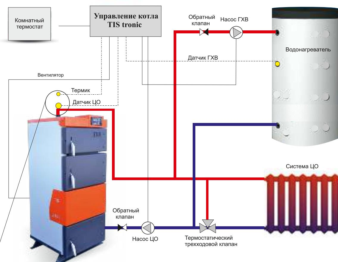
\* Схема подключения (представленная схема является примерной и упрощённой)
