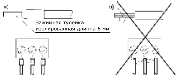
Рис. 13 Страховка концов провода: а) правильная, б) неправильная
