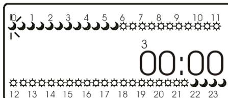
3. С помощью кнопок «+» и «-» установить соответствующий интервал времени. Для облегчения при выборе будет высвечиваться время интервала и пульсирующий символ «⚙» или «☾» .
