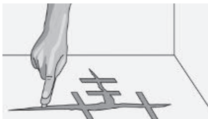
Рис. 2. Мелкие трещины сначала необходимо расширить до такой степени, чтобы жидкая смола (двухкомпонентная для ремонта трещин) могла легко проникать в них
