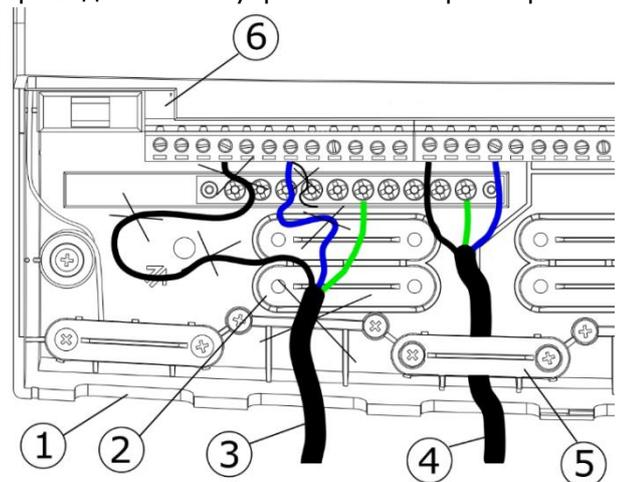
1 - кабельные отверстия, 2 - размещение хомутов (выломать из корпуса), 3 - правильное подключение проводов (запрещается скручивать лишние провода и оставлять неподключённые провода внутри
