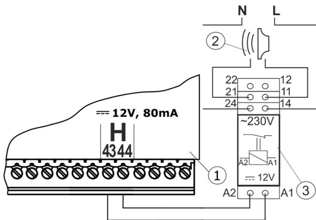
Подключение внешнего устройства оповещения, где: 1 - регулятор, 2 - внешнее устройство оповещения, 3 - реле, состоящий из реле RM 84-2012-35-1012 RELPOL и подставки GZT80 RELPOL,
