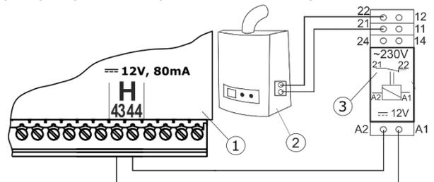
Схема подключения резервного котла к регулятору, где: 1 - регулятор, 2 - резервный котёл (газовый или дизельный), 3 - Модуль, состоящий из реле RM 84-2012-35-1012 и устан.коробки GZT80 RELPOL.
