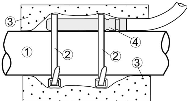
1 - труба, 2 - пластиковый хомут, 3 - термоизоляция, 4 - датчик температуры.
