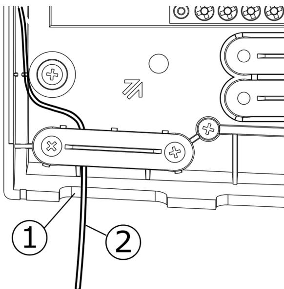
Вывод датчика капиллярного: 1 – ввод кабеля, 2 – правильное расположение капиллярного датчика STB.
