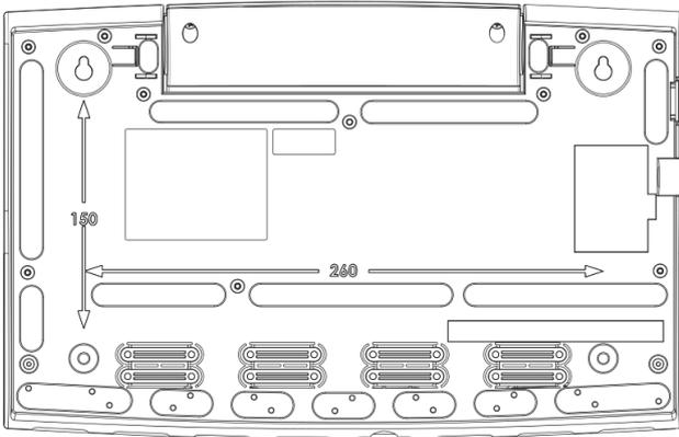
После монтажа необходимо убедиться, что устройство надёжно закреплено и не представляется возможным сорвать устройство с поверхности на которой регулятор был установлен.
