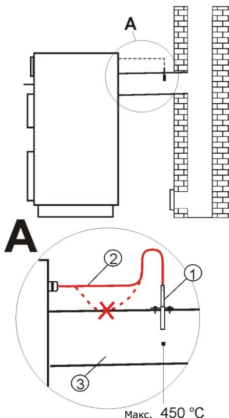
Подключение датчика отходящих газов: 1 – датчик температуры выхлопных газов СТ2S, 2 – провод датчика, 3 – дымоход.
