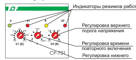
Реле контроля напряжения СР-731 выполнено в трехмодульном корпусе для крепления на DIN-рейке 35мм. На панели управления находятся индикаторы режимов работы, регуляторы нижнего и верхнего порога напряжения, регулятор задержки отключения.
