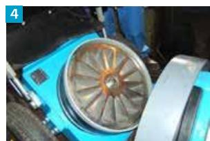
**Стоимость эксплуатации уменьшена на 30%** благодаря конструкции с одной уплотнительной плитой. Возможность многократной шлифовки уплотнительной плиты и дозирующего барабана позволяет существенно снизить эксплуатационные расходы
