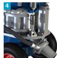
Конструкция с двойной подачей воздуха и мощным турбулентным выдувателем дает возможность использовать установку как **в сухом, так и мокром режиме** и делает ее **наиболее универсальной** для любых задач по торкретированию
