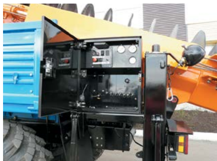
Пульт управления бурильной установкой МБШ
