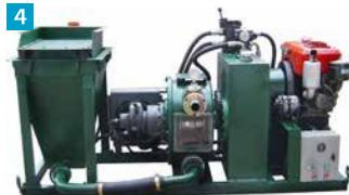
**Компоновка и комплектация согласно задачам строительного объекта** - на единой раме с растворным бункером, на салазках, колесах или самоходном шасси
