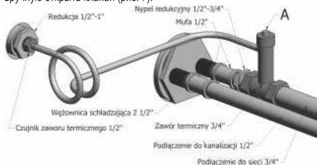
Рисунок 6. Способ подключения тепловой защиты.
