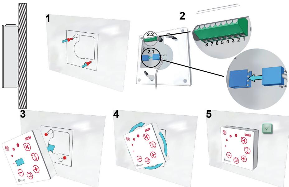
1. À l'aide du modèle fourni visser les vis à l'endroit choisi, en laissant l'écartement du mur de 1 mm.
