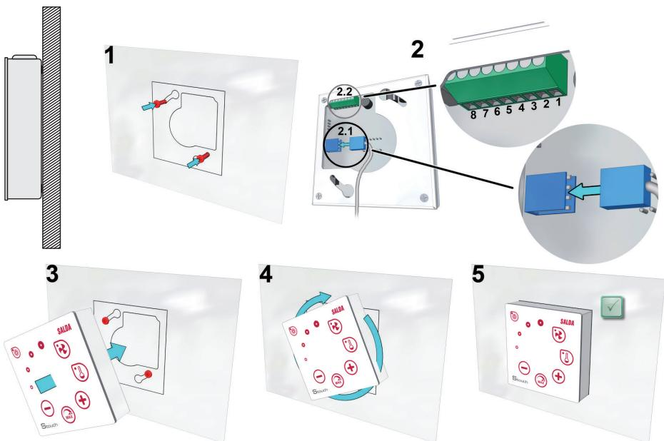
1. Laut dem vorgelegten Muster die Selbstschneideschrauben auf einem ausgewählten Platz mit einem 1 mm-Abstand von der Oberfläche einschrauben.
