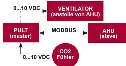
Mit Hilfe dieses Pults kann Niveau des Kohlendioxids (CO2) im Raum gesteuert werden. Am selben Pult muss der 0..10VDC-Föhler für CO2 angeschlossen und das Pult konfiguriert werden. Im Punkt F.14 des Servicebetriebs muss die Zahl 2 eingestellt werden, und in F.15 und F.16 wird sie laut Beschreibung des Föhlers angegeben.
