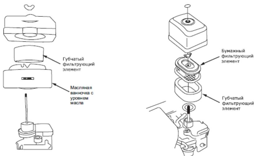
Рис.13 – Обслуживание фильтров
