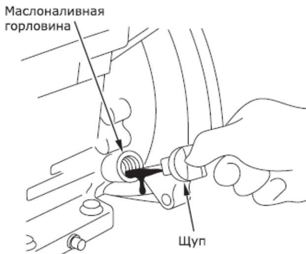
Рис. 2 – Контроль уровня масла в картере двигателя
