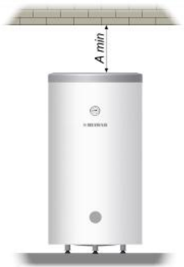
Рис. 4 Минимальное расстояние для обслуживания магниевого анода
