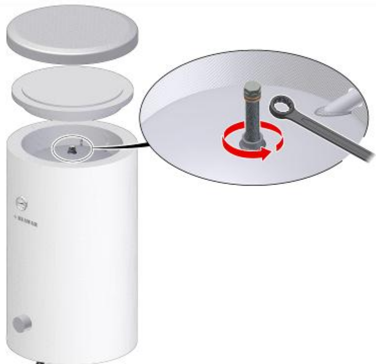
Рис. 8 Замена магниевого анода
