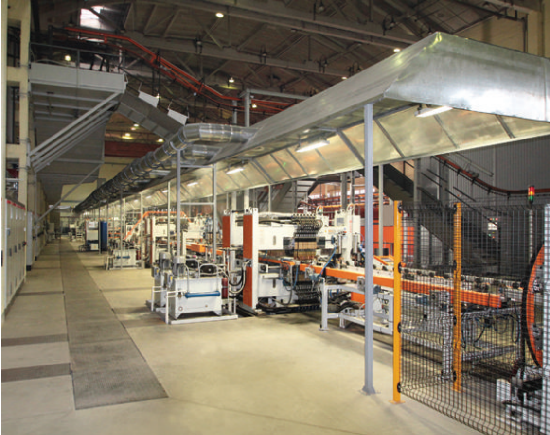
Новая современная автоматизированная линия сварки радиаторов «PRADO»
