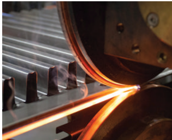
Сварка продольных швов панелей радиатора
