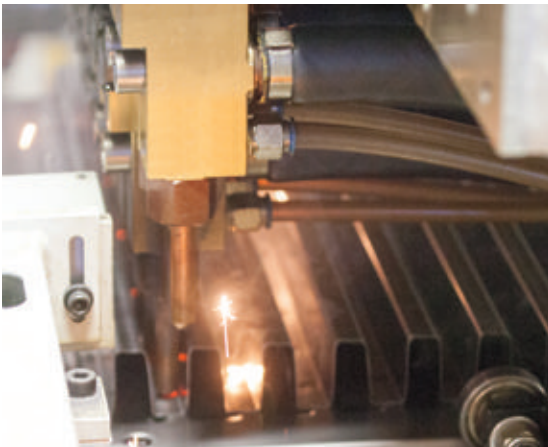
Сварка конвекционного листа с панелью радиатора
