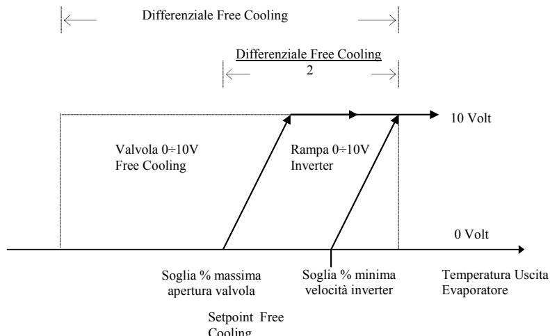
Устройства, как клапаны, так и вентиляторы, включаются во второй половине контрольного дифференциала вследствие действия интегрального управления. Такое включение определяется заданной константой интеграции. Чем больше значение времени интеграции, тем медленнее реагирует система.
