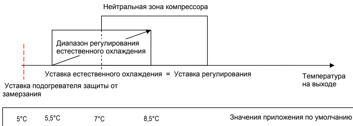
Диапазон пропорционального управления равномерно распределяется по сторонам от уставки. Пропорциональный диапазон равномерно распределяется по сторонам от уставки. В устройствах с контролем значения на входе и пропорциональным диапазоном контрольная уставка естественного охлаждения определяется с использованием смещения от контрольной уставки компрессора для компенсации наличия батареи испарителя.
