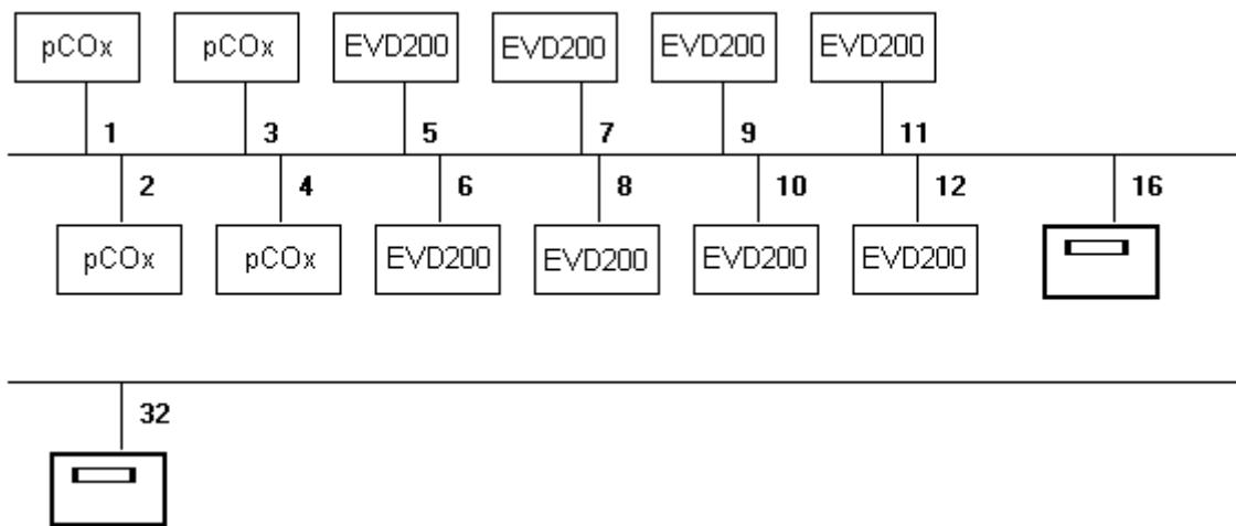
Основная маска M0 показывает адрес подсоединеной платы в нижнем левом углу. На терминале, показывающем 32, можно просматривать все платы без необходимости использования других терминалах.
