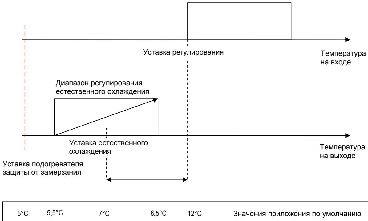
Диапазон пропорционального управления равномерно распределяется по сторонам от уставки. В диапазоне регулирования естественного охлаждения пороговые значения для включения соответствующих устройств (например, клапанов и вентиляторов или вариаторов скорости) рассчитываются различными способами в зависимости от типа регулирования, выбранного пользователем.
