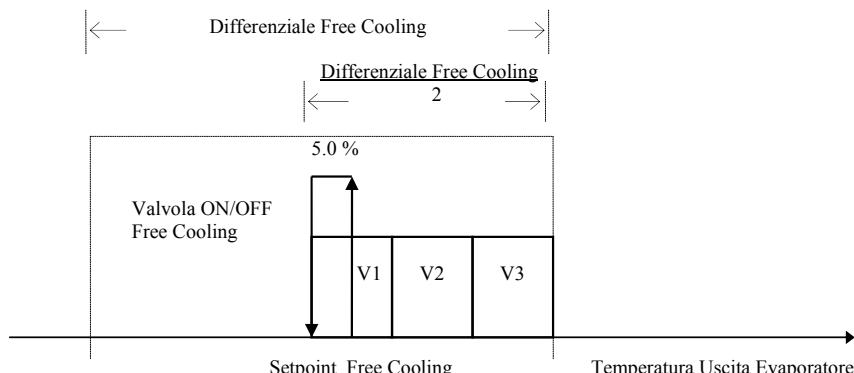
Устройства, как клапаны, так и вентиляторы, включаются во второй половине контрольного дифференциала вследствие действия интегрального управления. Их включение связано с заданной постоянной интегрирования: чем ниже скорость, тем больше значение конкретного параметра.
