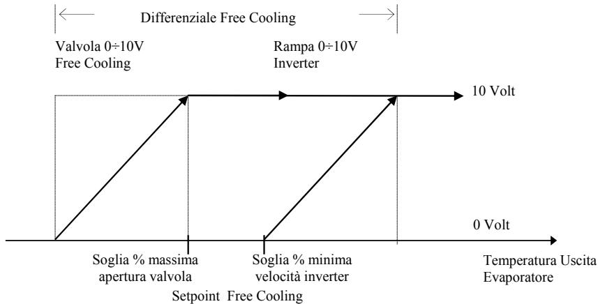
Пропорциональный диапазон управления клапаном естественного охлаждения рассчитывается в пределах области, определяемой пороговыми значениями:
