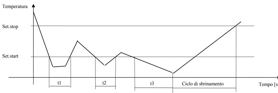
Если температура батареи/ давление находится ниже уставки пуска размораживания в течение совокупного периода, равного времени задержки размораживания, соответствующий контур переходит в цикл размораживания. Холодопроизводительность системы достигает максимального значения. Контур охлаждения реверсируется при помощи четырех-ходового клапана. Соответствующий вентилятор выключается (если имеются датчики давления).
