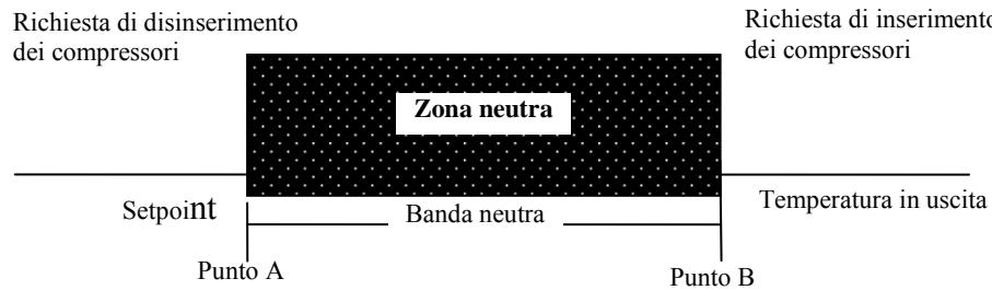
Нейтральная температурная зона определяется на основе значений уставки и диапазона регулирования.
