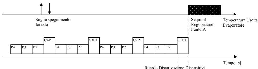
Если температура падает ниже порогового значения выключения, компрессоры останавливаются независимо от заданных задержек для предотвращения срабатывания аварийного сигнала защиты от замерзания.
