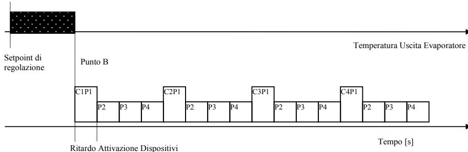
При такой конфигурации время между включением ступеней соответствует заданному времени между запусками различных компрессоров, в то время как, при регулировании производительности все еще применяется задержка между ступенями регулирования, следовательно, превалирует большее из двух значений времени.
