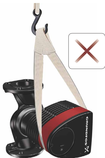
Рис. 6 Неправильный способ подъёма насоса
