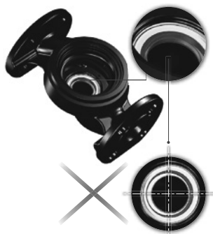
Рис. 15 Неправильно выровненная система уплотнений
