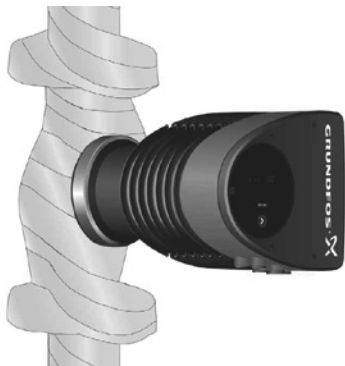
Рис. 17 Изоляция корпуса насоса и трубопровода
