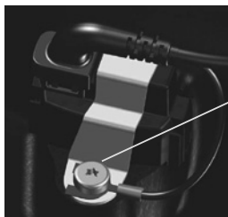
Рис. 44 Заземляющий провод датчика
