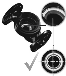
Рис. 15 Правильно выровненная система уплотнений
